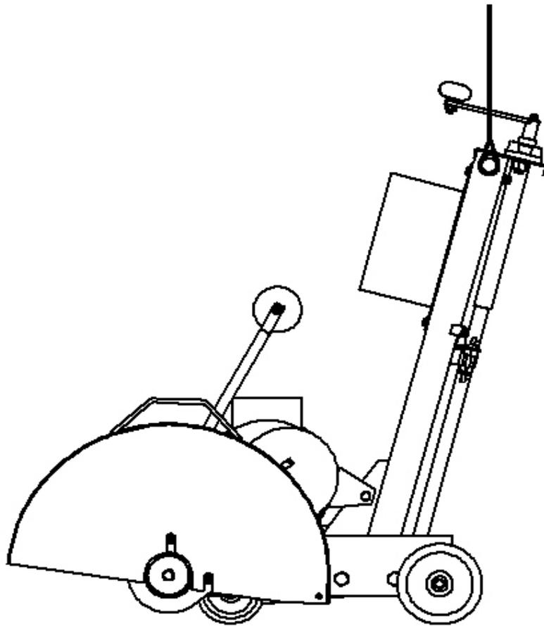
Рисунок 2 – Схема строповки нарезчика
